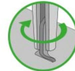
Twist the eyelet 45° / Закрутити вушко на 45° / Przekręć oczko o 45° Ruotare l'occhiello di 45° / Öse um 45° drehen / Tournez l'œillet à 45° Gire el ojal 45° / Torça o ilhó 45° / Закрутить ушко на 45° 將孔眼扭轉 45° / 구멍을 45° 비틀십시오 / アイレットを45°ひねる סובב את העין 45° / قم بلف العينية بزاوية 45 درجة
